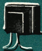
Fig. 11 - La figura illustra un tipo comunissimo di impedenza di filtro di tipo corazzato.
